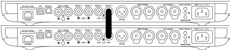
为您的系统设置双-单声道模式，请将扬声器连接到设备上，并用光纤电缆（S/PDIF或S/PDIF-AES/EBU）连接所有设备。
