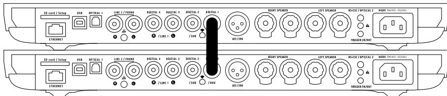
システムをデュアルモノモードに設定するには、各スピーカーを各機器に接続し、両方のスピーカーをデジタルケーブル (S/PDIF または S/PDIF-AES/EBU) で連結させてください。Companionの方の入力端子をご使用になりたい場合は、二台の機器も同様に、Masterのイン/アウトトリガコネクタからCompanionのRS232コネクタにアナログ式のステレオミニジャックケーブルを使って連結してください。
