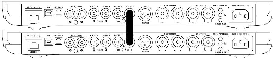
Pour configurer votre système en mode Dual-Mono, branchez chaque enceinte sur un appareil et reliez les par un câble digital (S/PDIF ou S/PDIF-AES/EBU).
