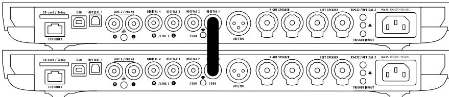
Para configurar su sistema en modo Dual-Mono, conecte cada altavoz a un dispositivo y conéctelos entre ellos por medio de un cable digital (S/PDIF o S/PDIF-AES/EBU).
