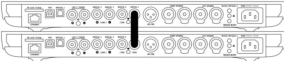
Per configurare il vostro sistema in modalità Dual-Mono, collegate ciascun diffusore ad un amplificatore e connettete i due amplificatori con un cavo digitale (S/PDIF o S/PDIF-AES/EBU).
